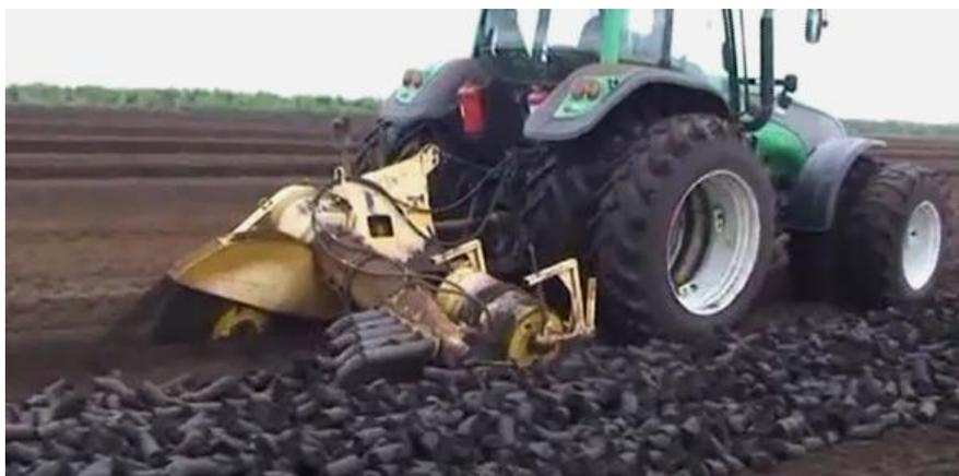
Рис. 1. Добыча торфа фрезформовочным методом
