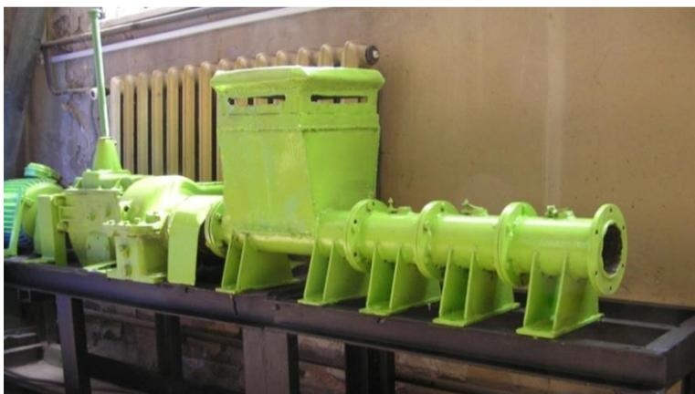
Рис. 2. Лабораторный шнековый пресс
