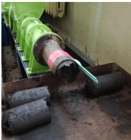
Рис. 5. Процесс формования торфа
