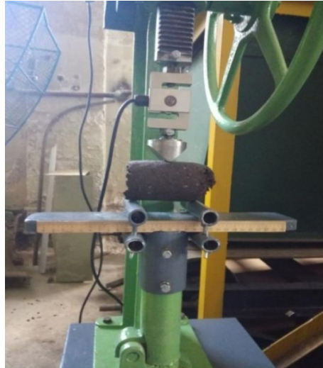
Рис. 3. Испытание на изгибную прочность образцов кускового торфа круглого сечения
