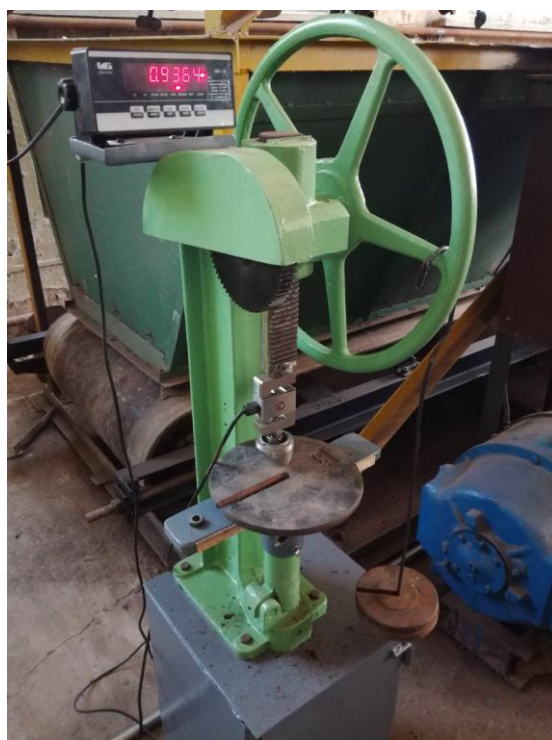
Рис. 2. Создание разрушающей нагрузки, развиваемой стендом при тарировании тензоскобы методом навешивания на штурвал калиброванных грузов
