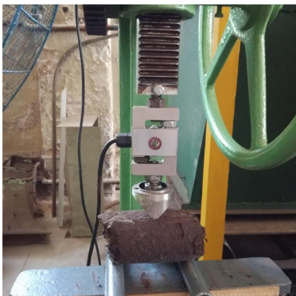
Рис. 1. Установка в тензоскобу дополнительных элементов
