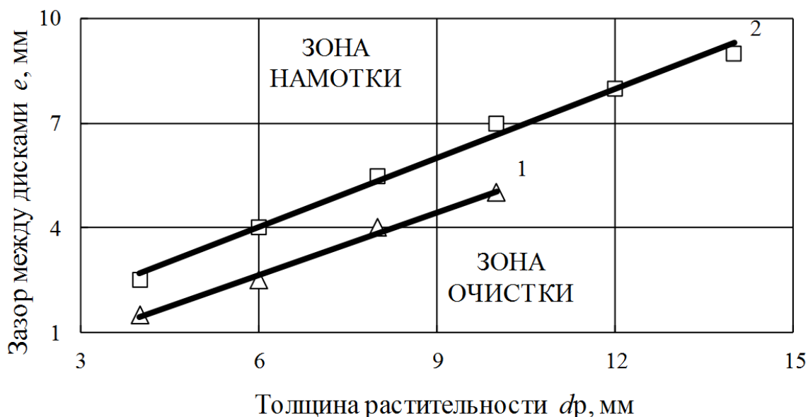
Рис. 4. Зависимость процесса намотки от зазора e и толщины поперечного сечения растительности dp : 1 – тростник; 2 – корневища
