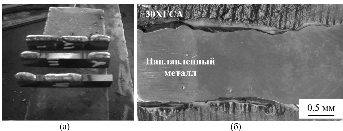
Рис. 3. Внешний вид образцов: после наплавки (а); продольного шлифа (б)
