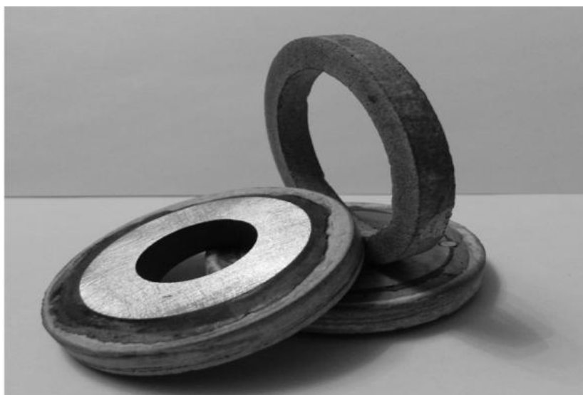
Рис. 4. Экспериментальные шлифовальные круги из композиционного материала
