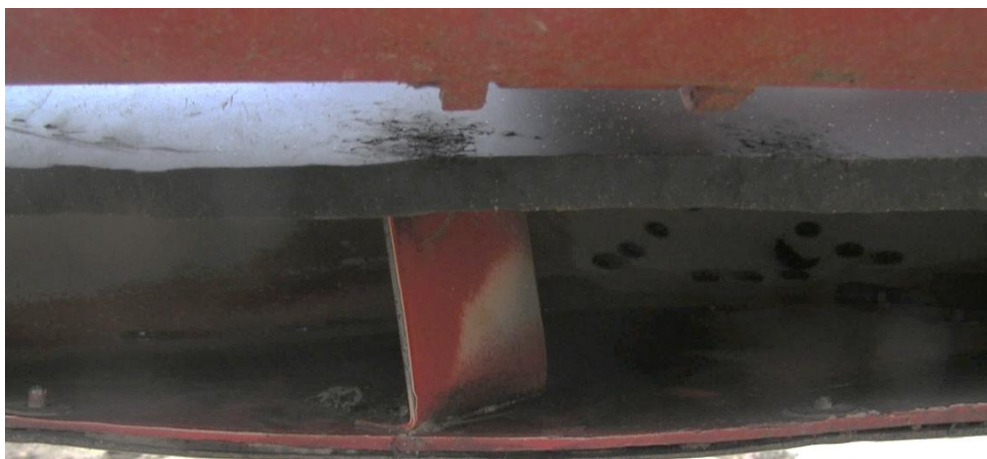
Рис. 5. Усилительное воздухонепроницаемое ребро, связывающее верхнюю и нижнюю кромки всасывающего сопла
