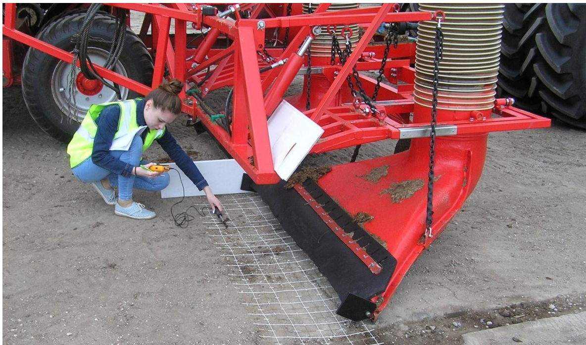
Рис. 3. Снятие показаний скорости воздушного потока перед соплом
