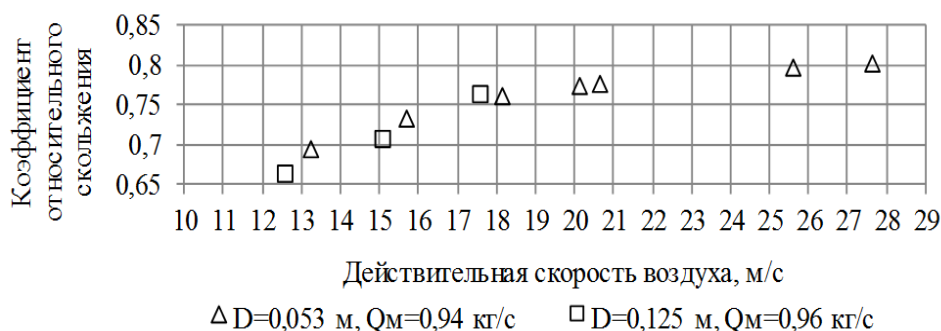
Рис. 5. Влияние диаметра пневмотранспортного трубопровода на коэффициент относительного скольжения
