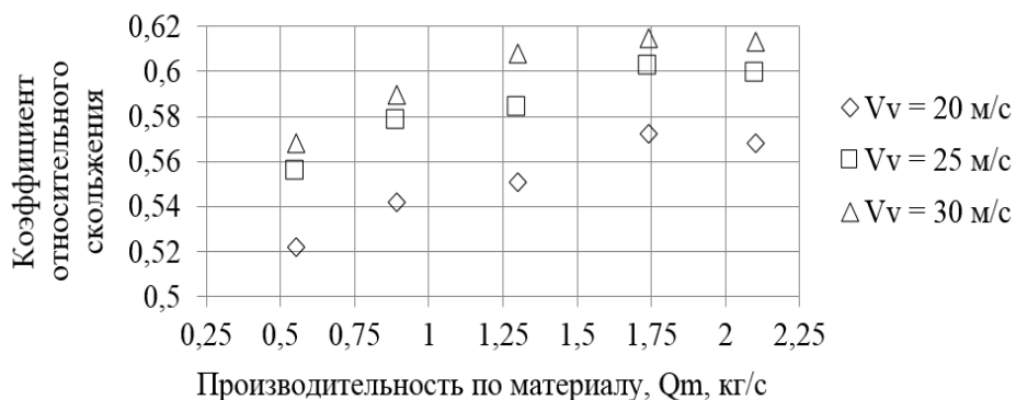
Рис. 6. Влияние массовой производительности по торфяным частицам на коэффициент относительного скольжения
