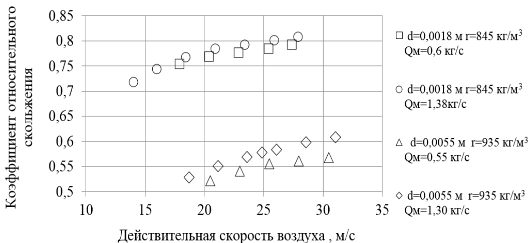
Рис. 3. Влияние на коэффициент относительного скольжения размера и плотности торфяных частиц
