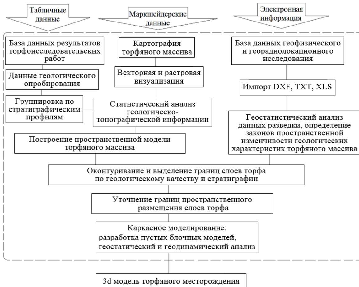
Рис. 1. Алгоритм разработки цифровой модели торфяного месторождения
