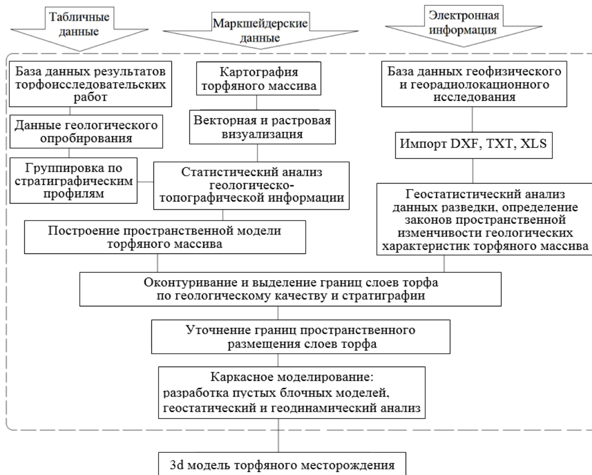
Рис. 1. Алгоритм разработки цифровой модели торфяного месторождения
