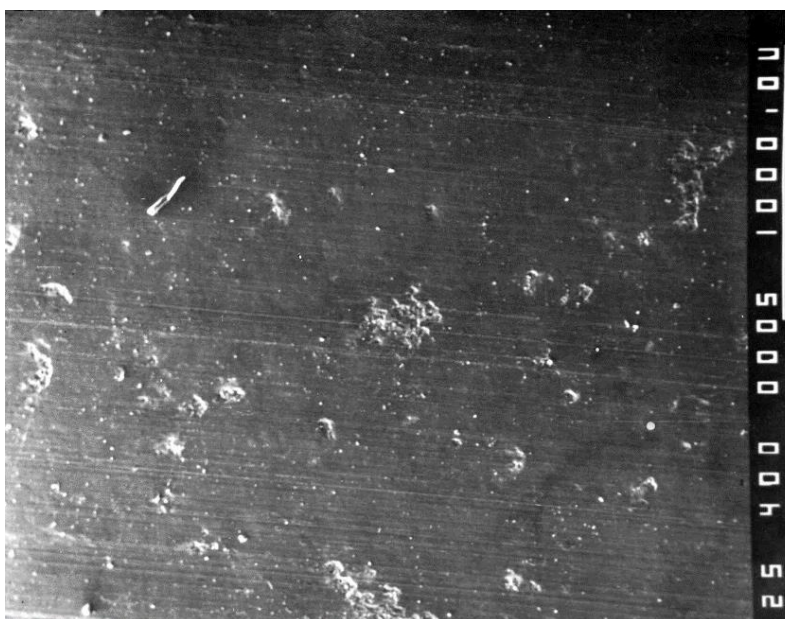
Рис. 3. Внешний вид приработанной поверхности образца с ТСП
