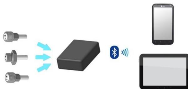
Рис. 1. Аппаратная архитектура датчика износа и температуры
