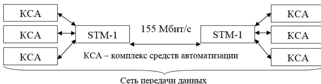
Рис. 1. Структурная схема сети передачи данных
