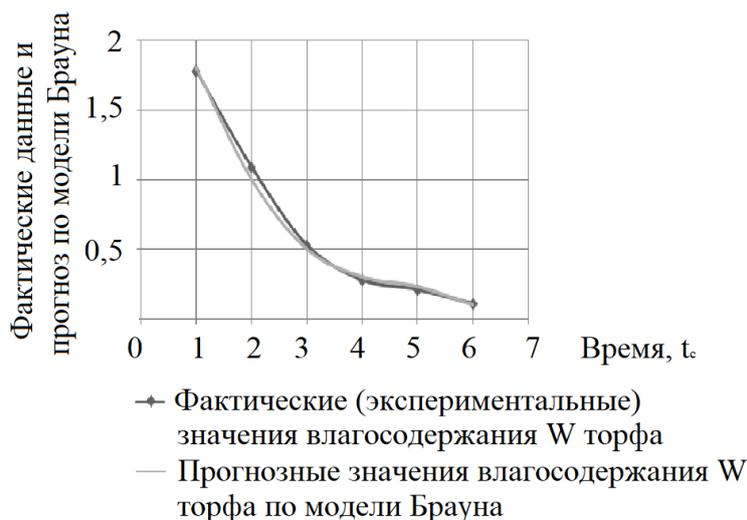
Рис. 5. Модель Брауна для эксперимента № 1
