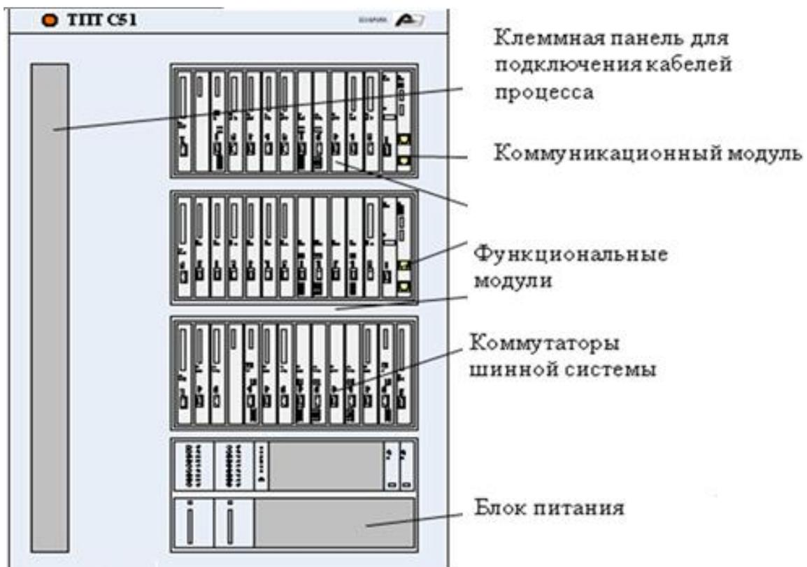
Рис. 2. Приборная стойка ТПТС51
