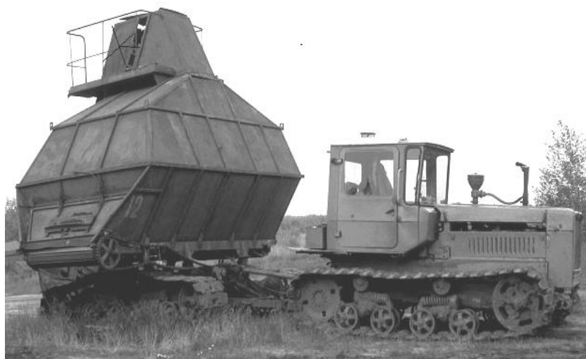
Рис. 2. Скреперно-бункерная машина с ковшовым элеватором, оборудованная крыльчаткой слежения
