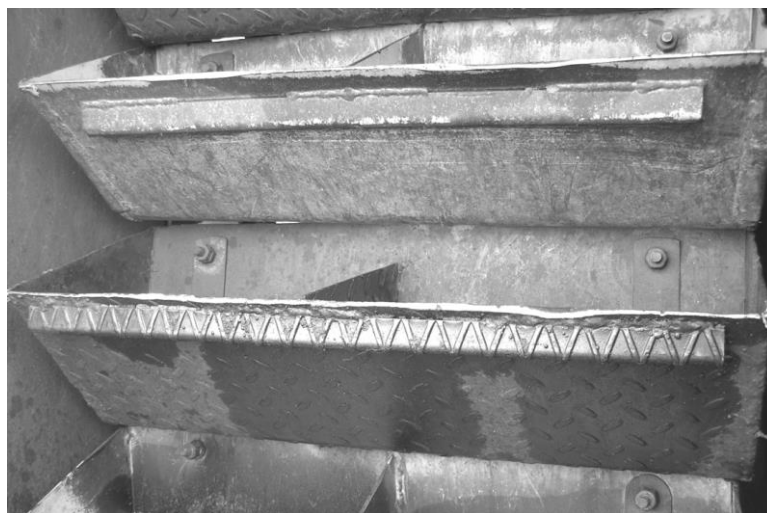
Рис. 3. Ковши элеватора, изготовленные из рифленого настила на ООО «Пиндstrup»
