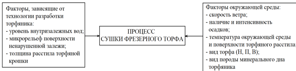
Рис. 1. Системные факторы, влияющие на скорость процесса полевой сушки фрезерного торфа
