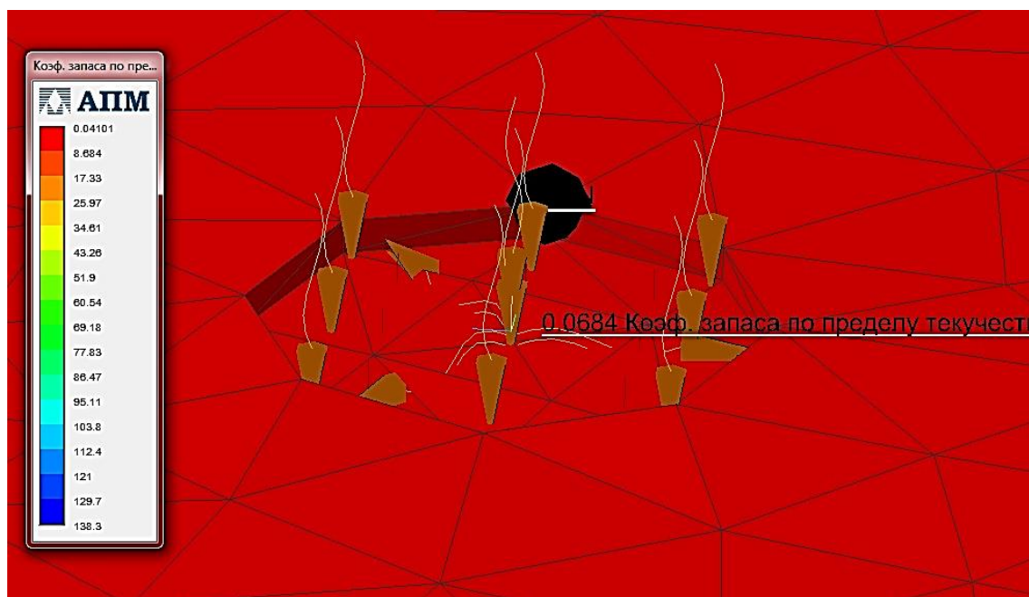
Рис. 2. Распределение значений коэффициента запаса прочности по пределу текучести быстрорежущей стали Р6М5 в зоне газолазерной резки
