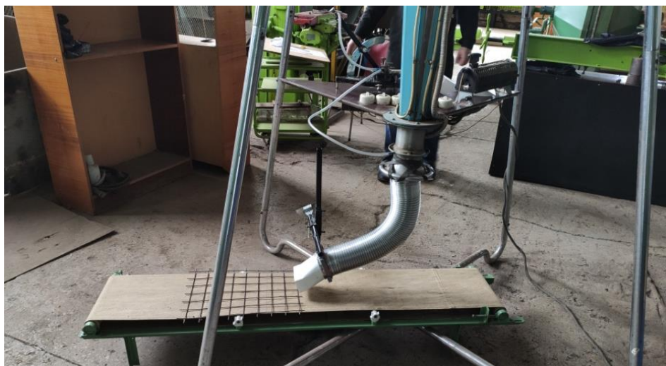
Рис. 4. Координатная сетка на ленте конвейера
