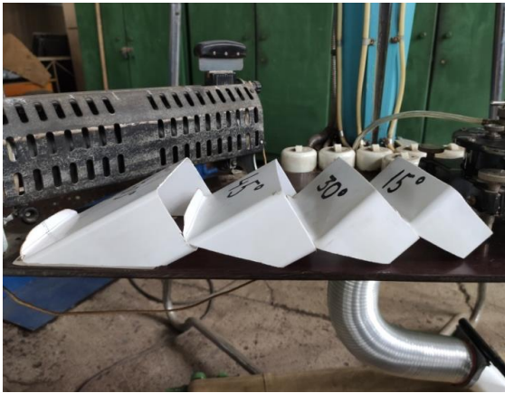
Рис. 5. Разработанные и изготовленные модели мундштуков на всасывающее сопло
