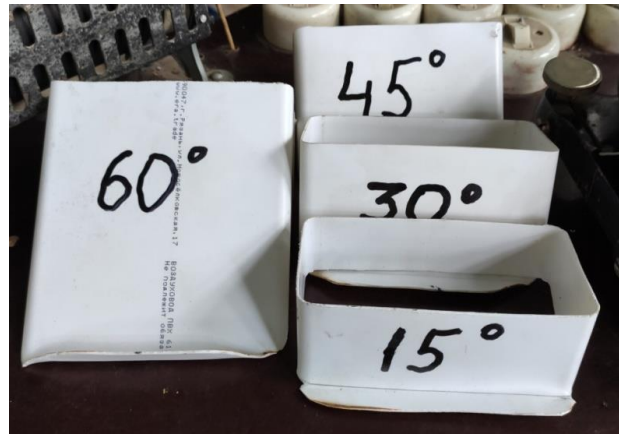
Рис. 5. Разработанные и изготовленные модели мундштуков на всасывающее сопло
