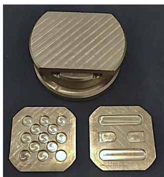
Рис. 2. Латунная литевая форма для отливки образцов футеровочных пластин на основе алюмооксидной керамики
