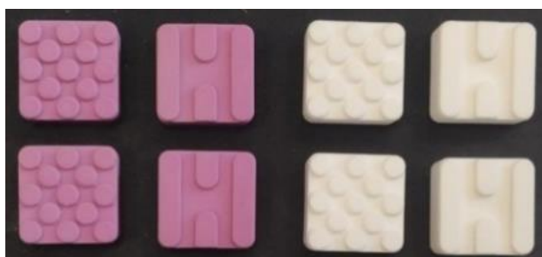
Рис. 3. Спеченные керамические образцы марки ВК-94 (слева) и марки А-995 (справа) с цилиндрическими и эллиптическими выступами
