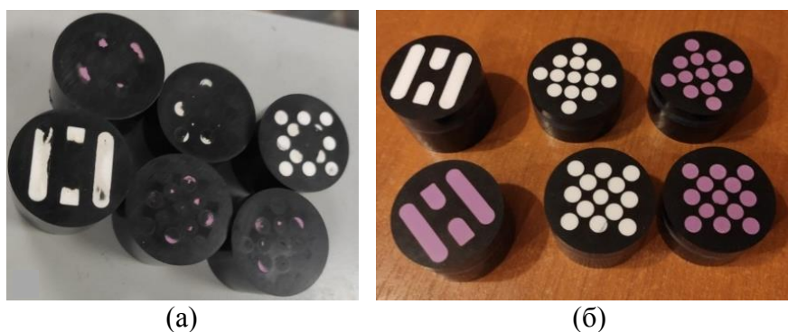
Рис. 4. Образцы для исследования свойств керамических материалов: запрессованные в бакелитовую смолу до шлифования (а); отполированные до получения зеркальной поверхности (б)
