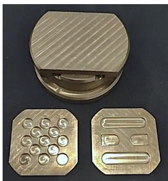
Рис. 2. Латунная литевая форма для отливки образцов футеровочных пластин на основе алюмооксидной керамики
