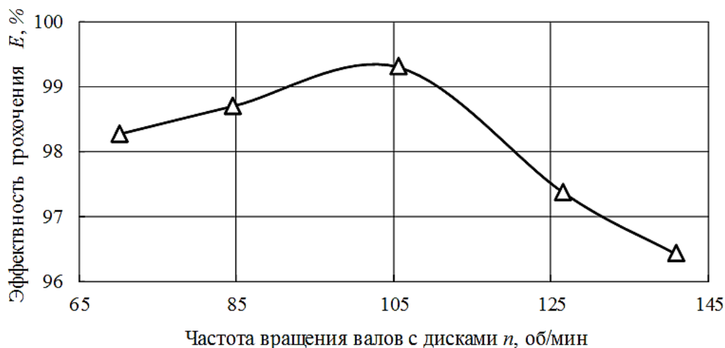
Рис. 2. Зависимость эффективности грохочения от частоты вращения дисков
