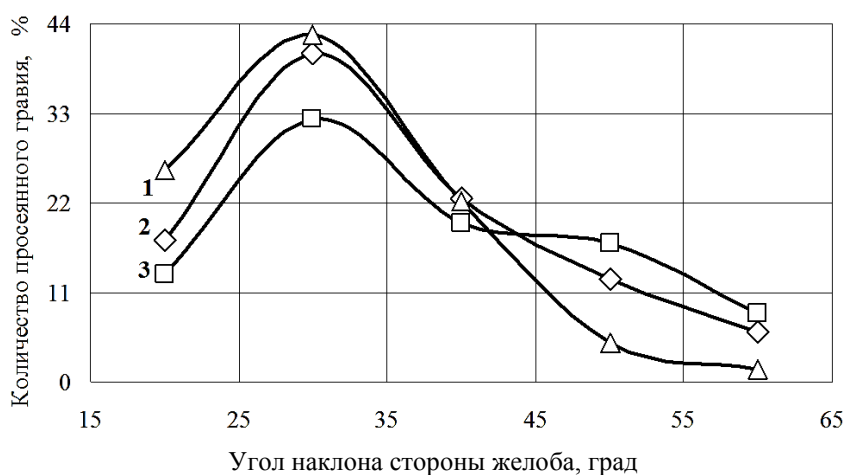
Рис. 7. Зависимость просеивания гравия по ширине желоба при частоте вращения валов с дисками, об/мин: 1 – 70; 2 – 105; 3 – 141
