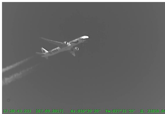
Рис. 4. Сопровождение самолета Boeing 747 (азимут – 016^{\circ}29'29'' ; угол места – 027^{\circ}31'55'' ; наклонная дальность – 21 810 м)
