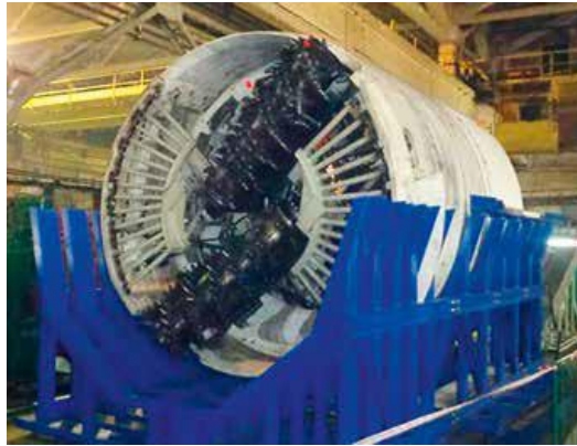
Рис. 2. Опытный образец ПА модели 401 диаметром 3,2 м
