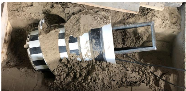
Рис. 5. Положение демонстрационного образца геохода после предварительных испытаний
