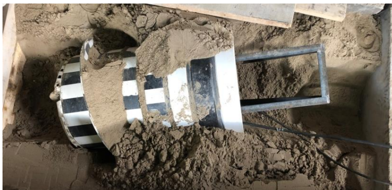
Рис. 5. Положение демонстрационного образца геохода после предварительных испытаний
