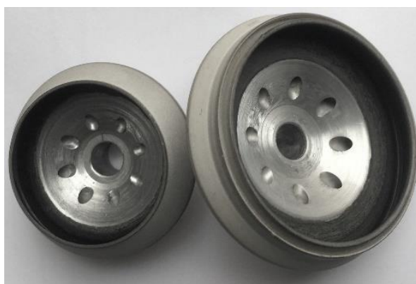
Рис. 1. Узел трения прядильной машины, модифицированный технологией микроплазменного оксидирования
