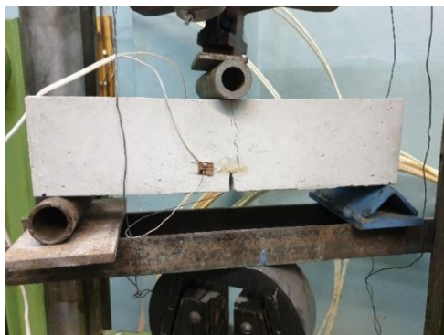
Рис. 3. Процесс разрушения образца карбонатного бетона
