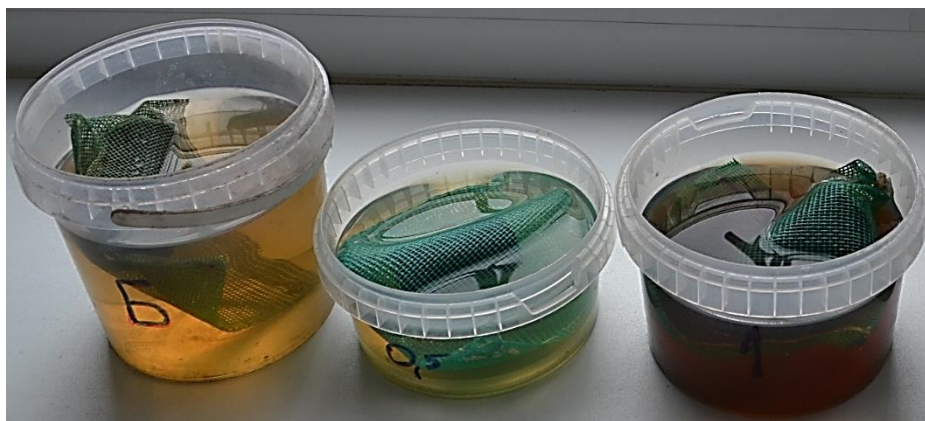
Рис. 5. Эксперимент по определению величины водопоглощения кускового торфа
