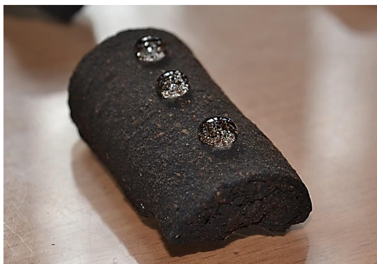
Рис. 6. Эксперимент по исследованию водоотталкивающих свойств кускового торфа
