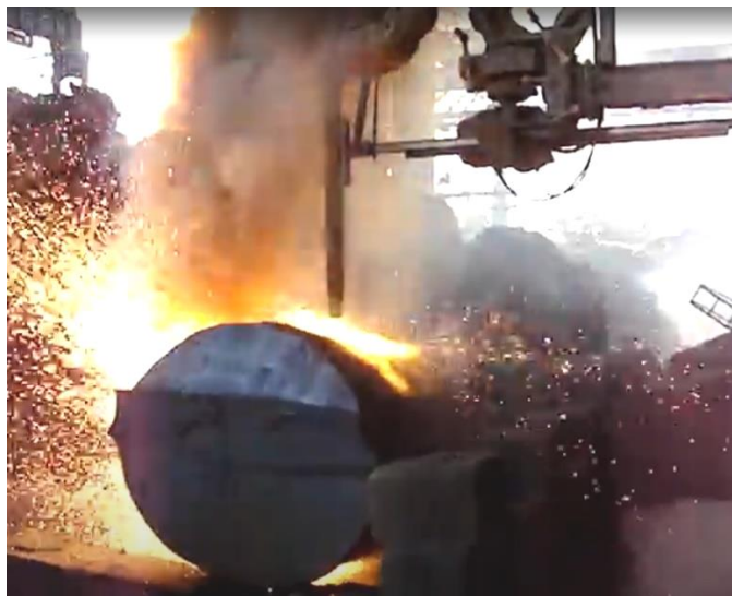
Рис. 1. Вид рабочей зоны раскроя скрапа
