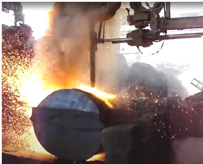
Рис. 1. Вид рабочей зоны раскроя скрапа
