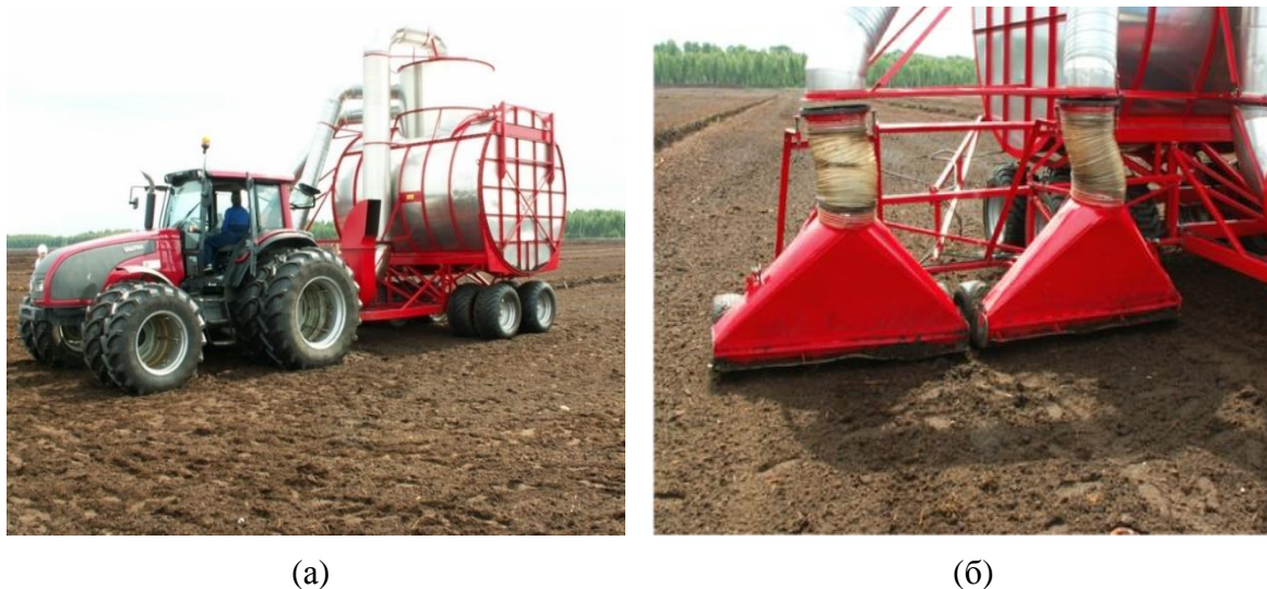
Рис. 5. Пневмоуборочная машина МПТУ-30: общий вид (а); всасывающие сопла уборочной машины (б)
