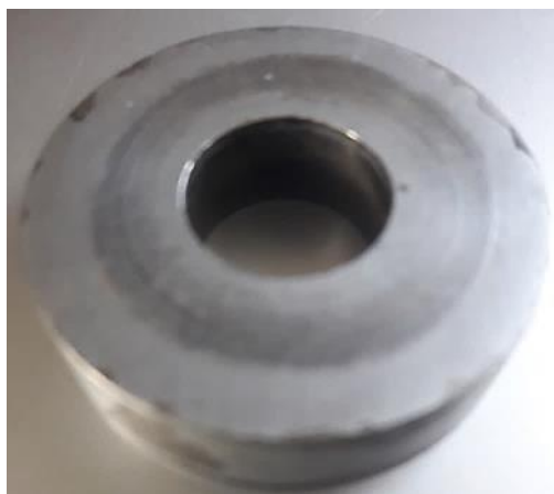
Рис. 2. Изображение образца после испытаний на износ
