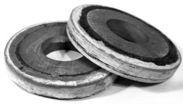
Рис. 2. Испытываемые образцы минералокерамических абразивных кругов
