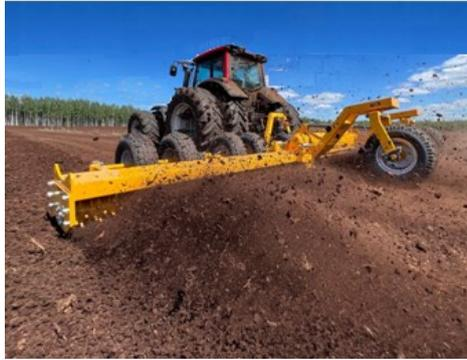
Рис. 1. Процесс фрезерования торфяной залежи верхового типа
