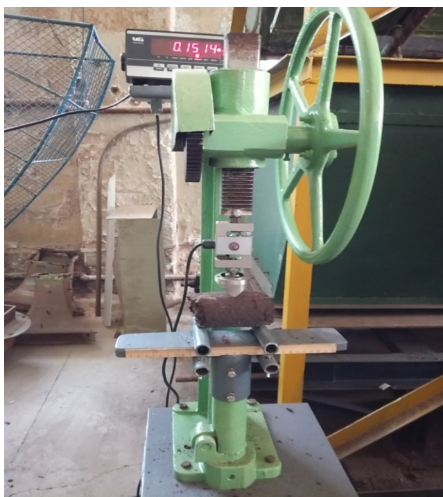
Рис. 1. Стенд для испытания на изгибную прочность формованного торфа
