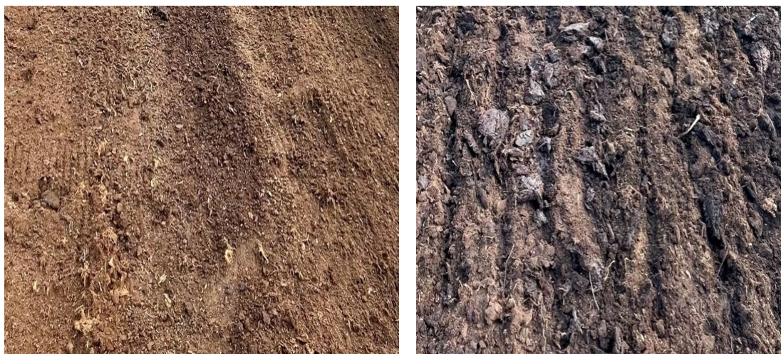
Рис. 3. Виды расстила торфяной крошки после фрезерования: МТФ-14 и ФПТ-09 (а); ПТ-09 (б)
