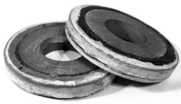
Рис. 2. Испытываемые образцы минералокерамических абразивных кругов
