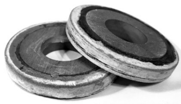
Рис. 2. Испытываемые образцы минералокерамических абразивных кругов
