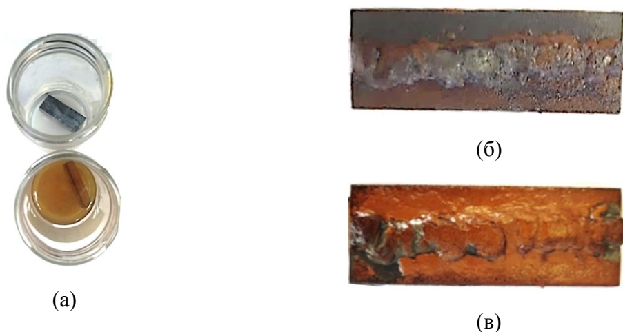
Рис. 3. Фотографии стальных сварных образцов с покрытием и без него при испытании в морской воде в течение 10 сут (а) и после извлечения образцов без покрытия из раствора через 4 сут (б); 10 сут (в)
