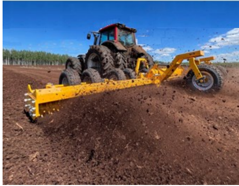
Рис. 1. Процесс фрезерования торфяной залежи верхового типа
