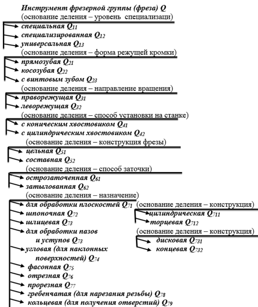
Рис. 2. Деление объемородового понятия фреза ( Q ) на объемовидовые в зависимости от основания деления
