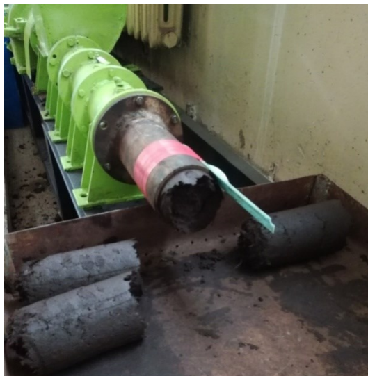
Рис. 1. Формование кускового торфа цилиндрического сечения на шнековом прессе
