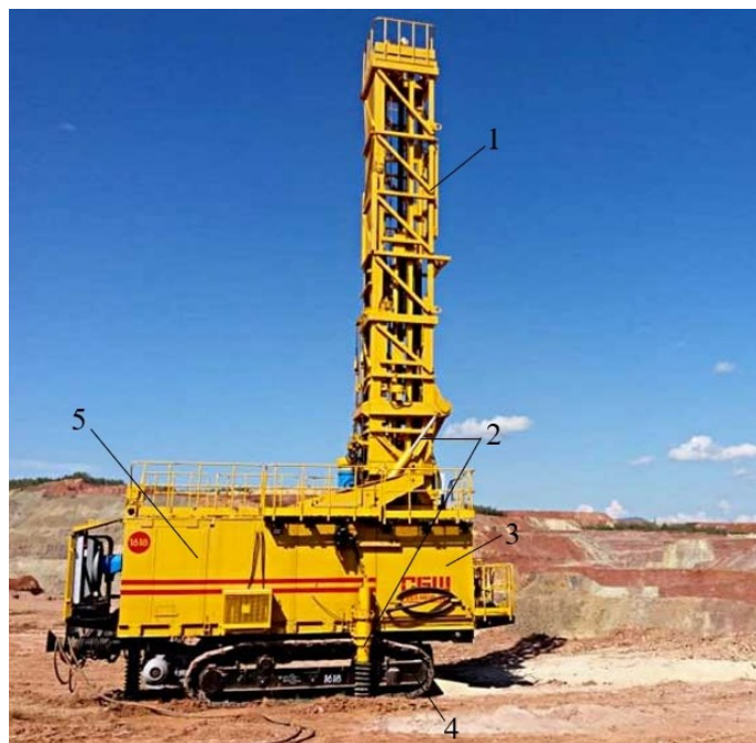
Рис. 1. Буровой станок СБШ: 1 – мачта; 2 – гидроцилиндры; 3 – кабина машиниста; 4 – тележка (гусеничная); 5 – машинное отделение
