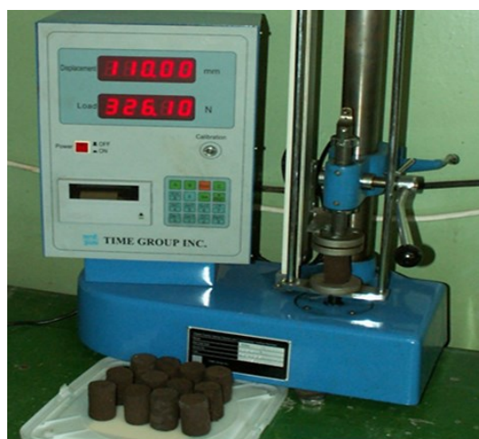
Рис. 1. Экспериментальная установка для испытания цилиндрических кусков на сжатие
