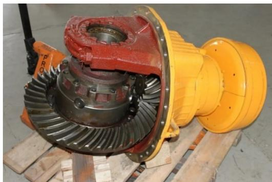
Рис. 1. Главная передача заднего моста самосвала БелАЗ
