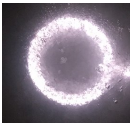
Рис. 1. Процесс электролитического формирования алмазного керамического покрытия
