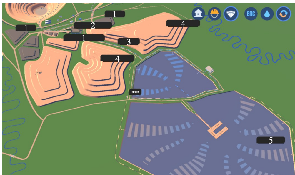
Рис. 1. Производственная площадка: 1 – склад руды; 2 – обогатительная фабрика; 3 – трубопровод; 4 – отвал пустых пород; 5 – хвостохранилище [20]
