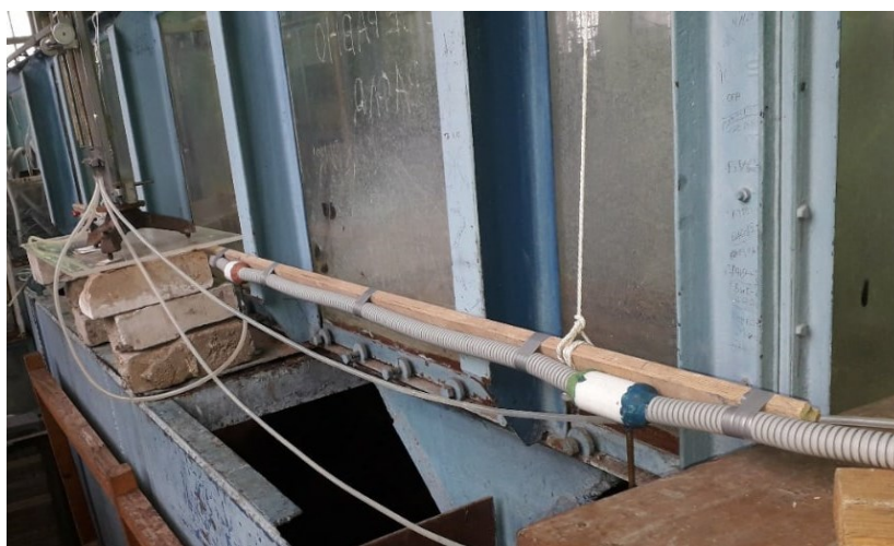
Рис. 5. Крепление пьезометров к горизонтально расположенной ПВХ трубе
