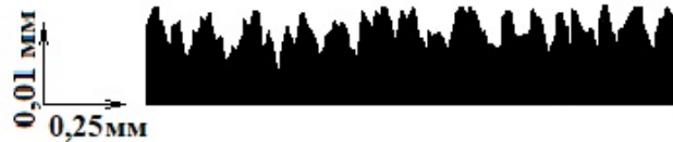
Рис. 3. Профилограмма поверхности трения АКМ после приработки: d = 80/63; K = 50 \%
