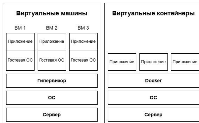
Сравнение виртуальной машины и виртуального контейнера
