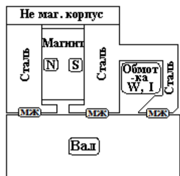
Рис. 7. Конструкция опытного управляемого МЖГ
