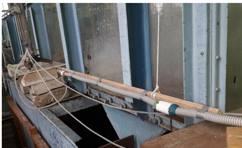
Рис. 5. Крепление пьезометров к горизонтально расположенной ПВХ трубе
