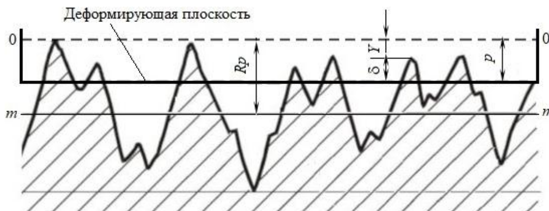
Рис. 3. Схема контакта шероховатой поверхности с гладким плоским штампом: 00 – исходное положение штампа; mm – средняя линия профиля шероховатости
