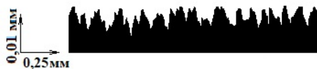
Рис. 3. Профилосограмма поверхности трения АКМ после приработки: d = 80/63; K = 50 \%
