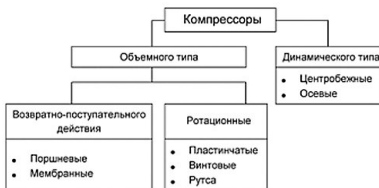
Рис. 1. Структурная схема ТС «Компрессор»
