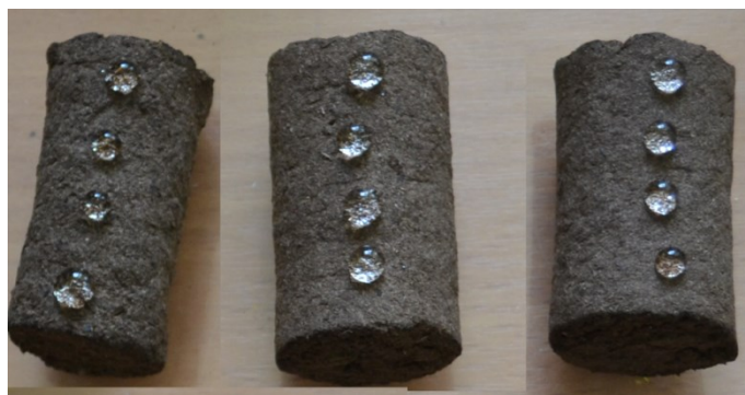
Рис. 3. Эксперимент по определению водоотталкивающих свойств гидрофобно-модифицированного кускового торфа
