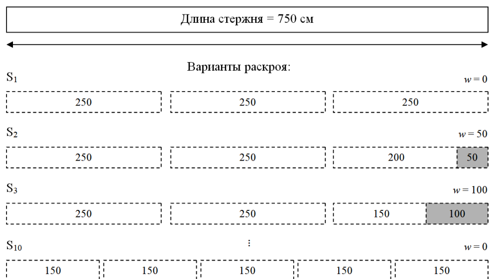
Рис. 2. Визуализация плана раскроя арматурных стержней длиной 750 см
