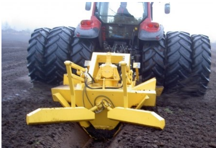
Рис. 3. Шнековый канавокопатель КШ-1,3К [11]
