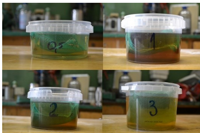
Рис. 2. Эксперимент по исследованию водопоглощительных свойств гидрофобно-модифицированного кускового торфа
